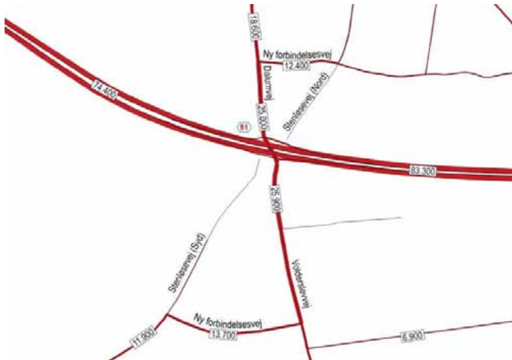
FIGUR 7.10 Ombygning af eksisterende tilslutningsanlæg 51, Odense S og nye forbindelsesveje nord og syd for motorvejen, ADT 2020. Stregens tykkelse viser trafikens omfang.
