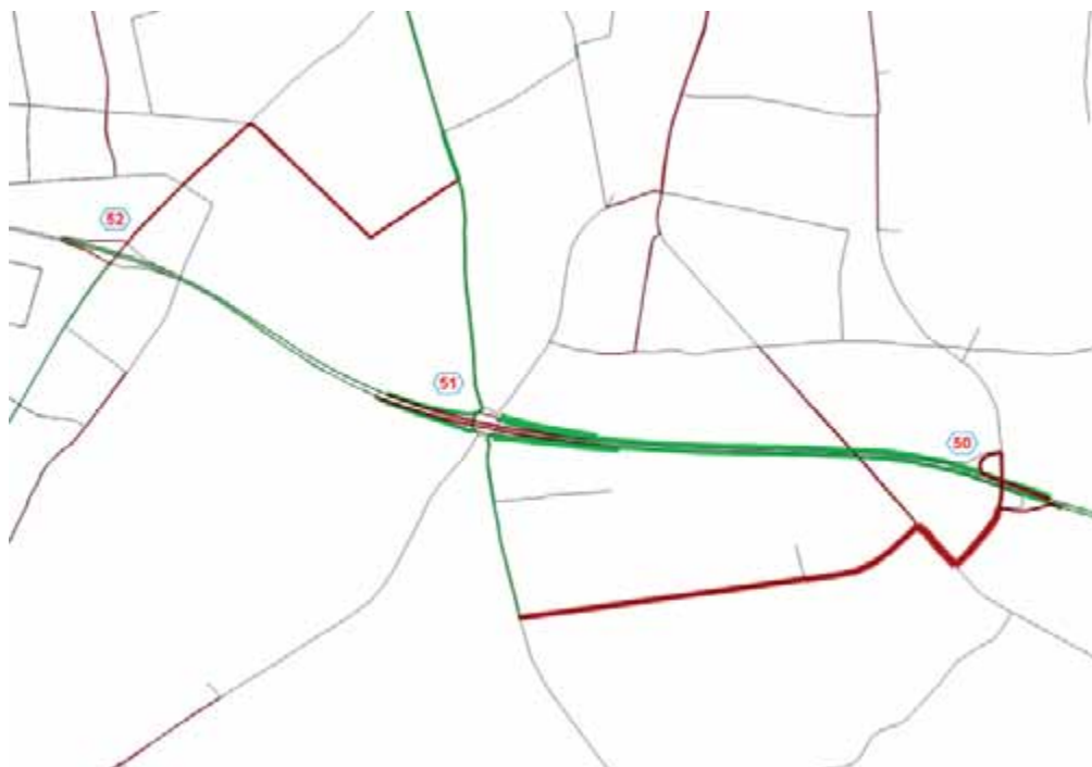
FIGUR 7.11 Nedlæggelse af ramper i tilslutningsanlægget Odense S. Rød farve viser trafikvækst og grøn farve hvor trafikken mindskes. Stregens tykkelse viser trafikens omfang.
