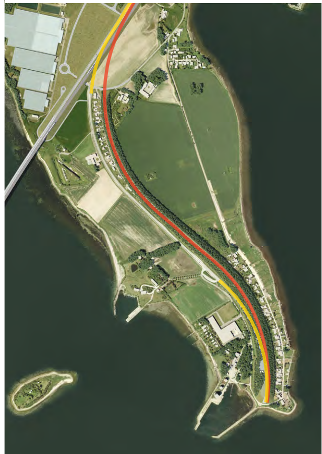
Figur 6.10 Nedrivning af jernbane og vejbelægning på Masnedø, markeret med hhv. rød og gul streg.
