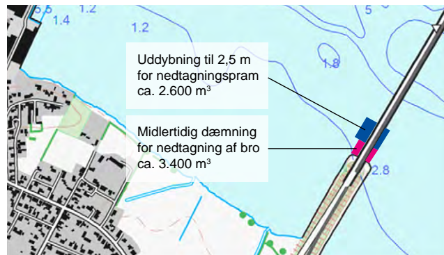
Figur 6.14 Midlertidige dæmninger og arbejdskanaler på Falster til nedtagning af bro
