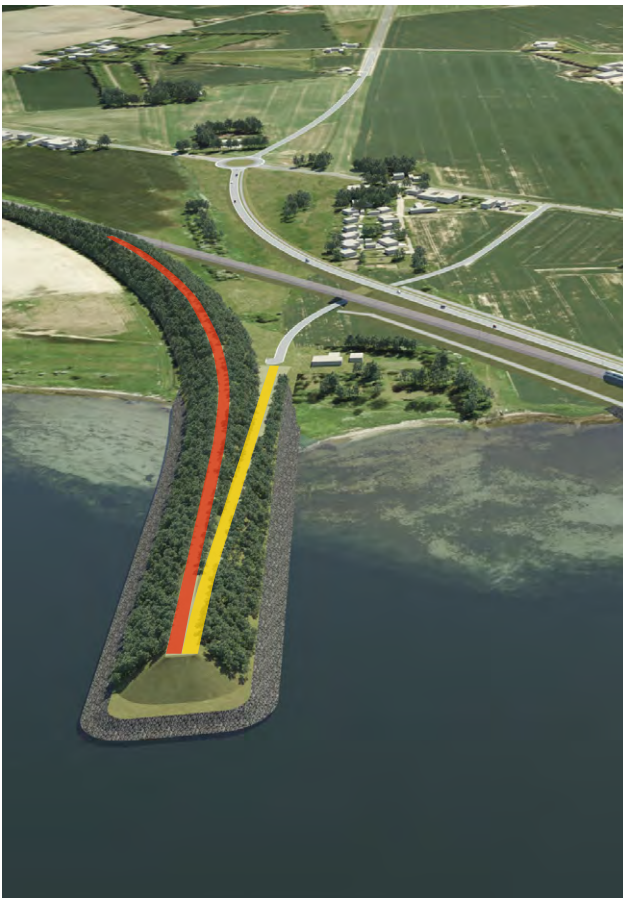
Figur 6.9 Nedrivning af jernbane og vejbelægning på Falster, markeret med hhv. rød og gul streg.
