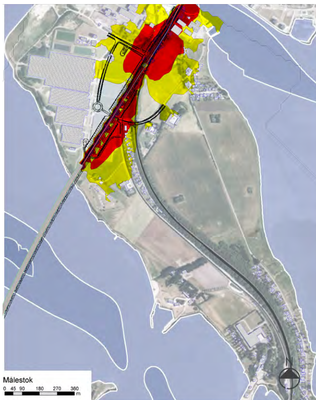
Figur 9.4 Jernbanestøj Masnedø - Ny Storstrømsbro
