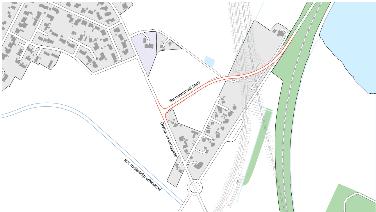
Figur 5.12 Oversigtskort med nye lokalveje som anvendes i anlægsperioden, Falster. Underføring af Storstrømsvej under den nye dæmning er ikke endeligt afklaret.
