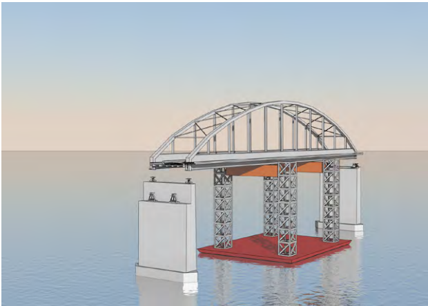
Figur 6.4 Nedtagning af buefag vha. løftetårne placeret på pram
