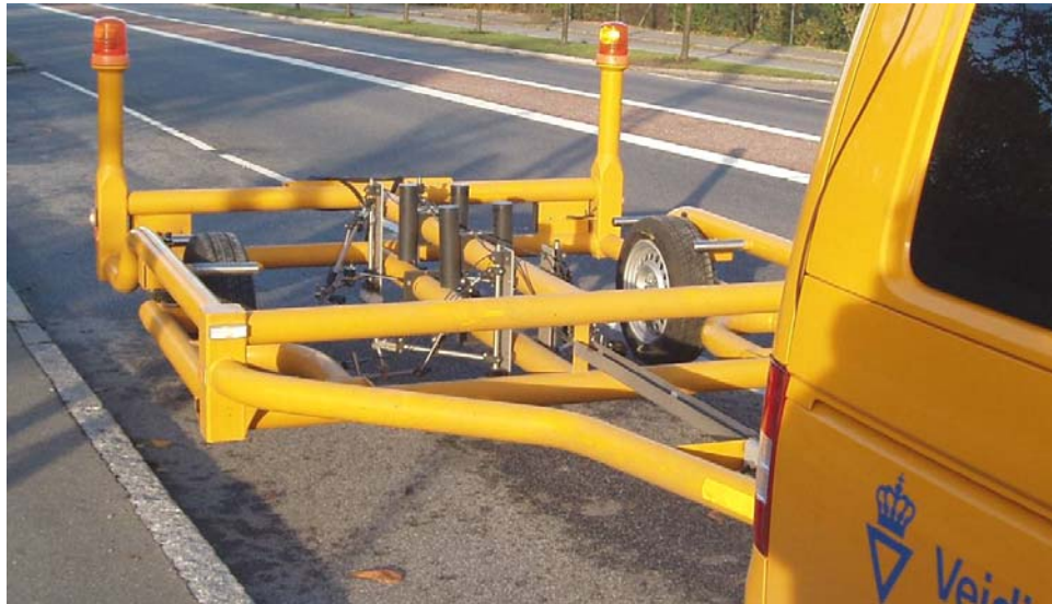
Figur 6.5. CPX-traileren "deciBella" som anvendes af Vejdirektoratet/Vejteknisk Institut.
