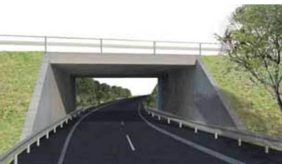
Koncept for tunnelunderføring med lodrette endevæderlag
