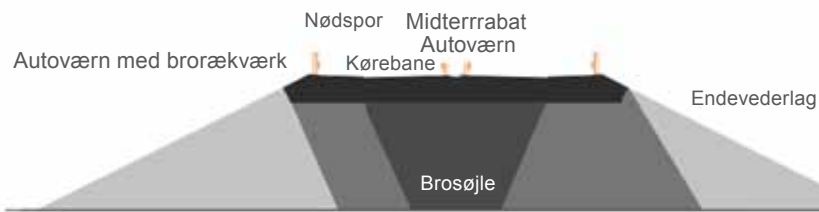
Tværsnit af overføring med trapezformet søjle
