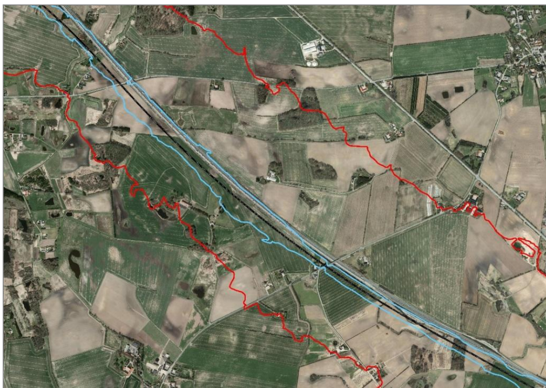
Figur 35: Illustration af udbredelse af vej- og jernbanestøj svarende til støjtypernes respektive grænseværdier. Rød linje repræsenterer vejstøjen ved L_{den} = 58 dB(A) og blå linje jernbanestøjen ved L_{den} = 64 dB(A).
