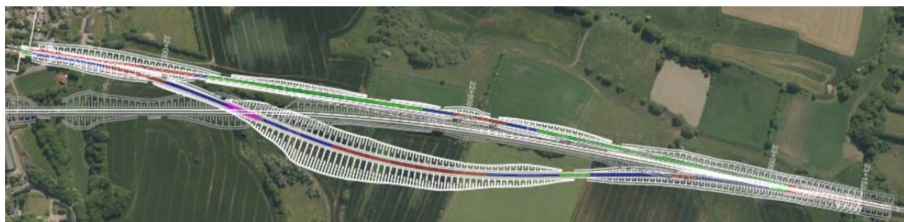
Figur 5-11. Niveaufri udfletning mellem Brejning og Børkop hvor begge spor fra Vejle mod Fredericia føres under hovedlinjen (ses ikke på dette udsnit) og højre spor fra Vejle mod Fredericia føres under hovedlinjen igen, inden sporene sammenfletter, variant 4 syd. Kan kun anvendes ved linjeføring A og C. Nord er mod venstre.
