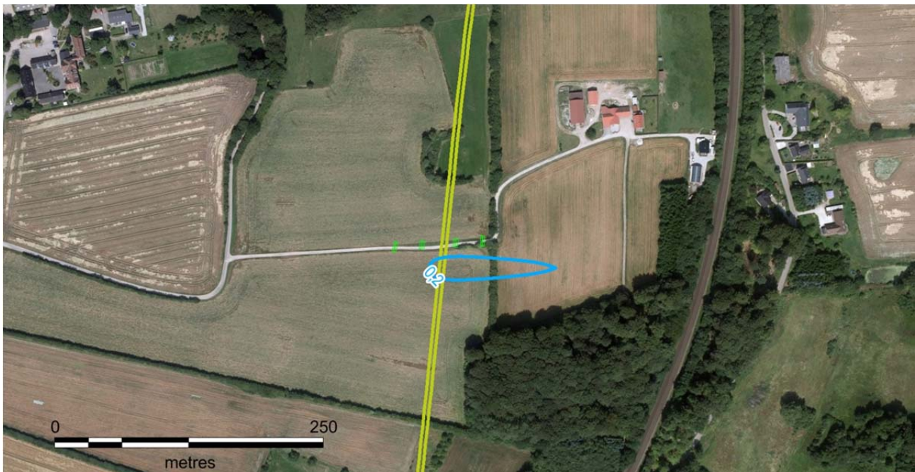
Figur 15-11. Udbredelse af midlertidig sænkning (m) i det terrænnære grundvand ved bygværk C5, linjeføring C. Iso-kurverne viser, hvor meget lavere (m) grundvandsspejlet står i forhold til de eksisterende forhold.
