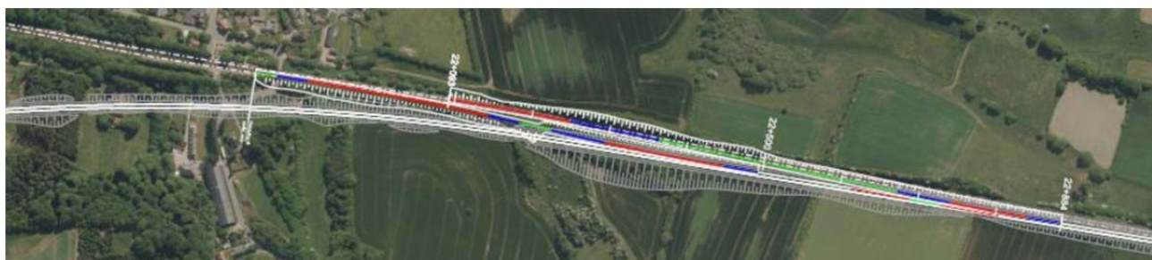
Figur 5-12. Udfletning i niveau mellem Brejning og Børkop, hvor begge spor fra Vejle mod Fredericia føres under hovedlinjen (ses ikke på dette udsnit), inden de sammenfletter med hovedlinjen i niveau, variant 5 syd. Kan kun anvendes ved linjeføring A og C. Nord er mod venstre.
