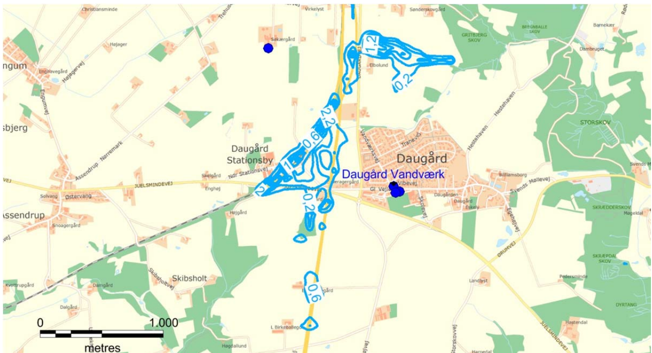
Figur 15-21. Udbredelse af permanent sænkning i det terrænnære grundvand nord for Vejle Fjord, linjeføring D. Iso-kurverne viser, hvor meget lavere (m) grundvandsspejlet står i forhold til de eksisterende forhold. Vandindvindingsboringer er vist med blå prik.
