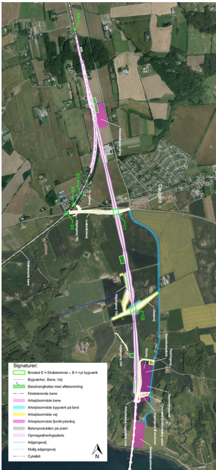
Figur 5-15. Udkast til planlagte landanlæg for linjeføring C (Rambøll, 2016c). Venste billede viser den nordlige side af Vejle Fjord med Hedensted Station og højre billede den sydlige side af fjorden ved Brejning. Bygværker er angivet med grønne bogstaver.
