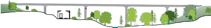
Figur 8-9. Opstalt af dalbroen på linjeføring C med overføring over eksisterende bane (Vejdirektoratet, 2016a).
