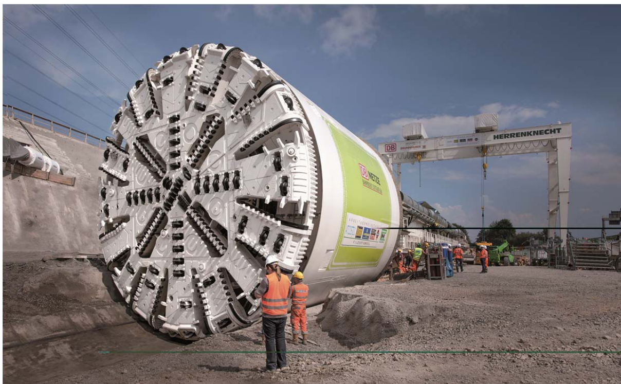
Figur 5-21. Et eksempel på en tunnelboremaskine (TBM) som vil kunne anvendes til at bore tunnelen under Vejle Fjord. Foto: Herrenknecht.com.
