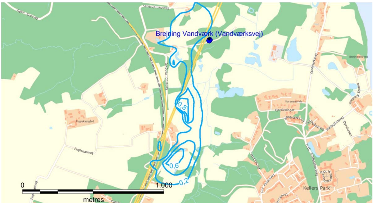
Figur 15-18. Udbredelse af midlertidig sænkning i det terrænnære grundvand syd for Vejle Fjord, linjeføring D. Iso-kurverne viser, hvor meget lavere (m) grundvandsspejlet står i forhold til de eksisterende forhold. Vandindvindingsboringer er vist med blå prik.
