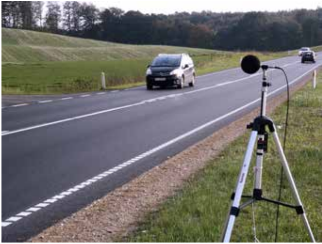
FIGUR 9. Støjmålinger på demonstrationsstrækninger med støjreducerende vejbelægninger ved Igelsø på hovedlandevej 145 mellem Holbæk og Sorø.
