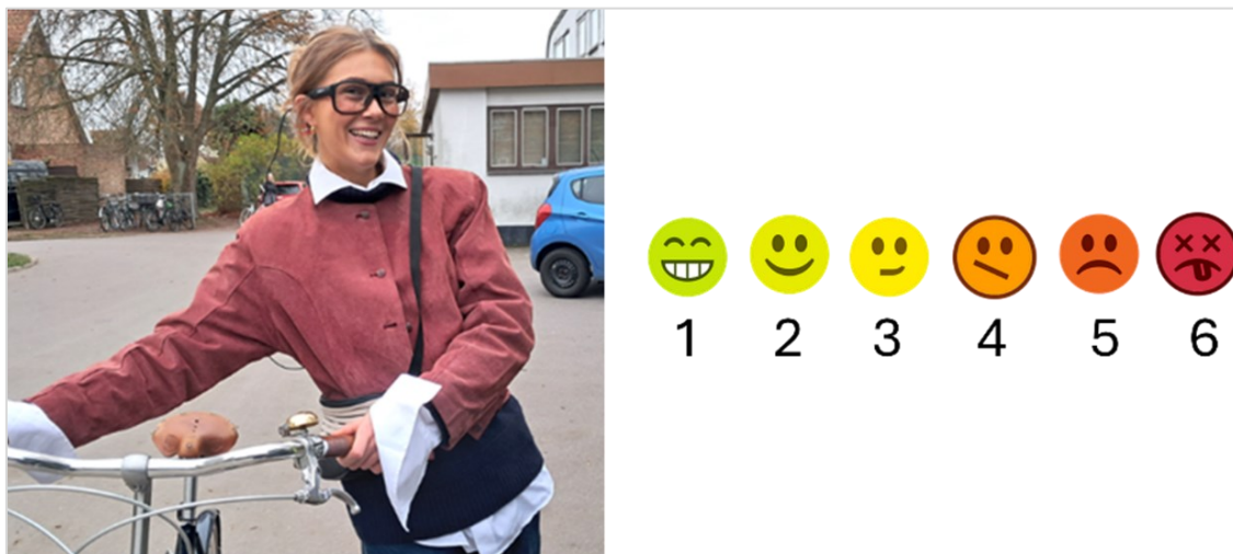
Figur 33. Til venstre ses testcyklist iført eyetracking-brille og øvrigt udstyr til måling af visuel adfærd. Til højre ses illustration af seks-punktsskala anvendt til cyklisters vurdering af forhold ved vejarbejde. (Foto og illustration: Trafitec 2024).
