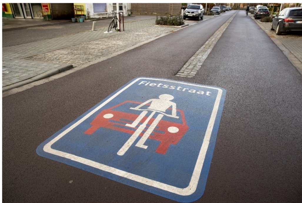
Figur 6.7: Tydelig begyndelse på en cykelgade og et afvigende kørebaneprofil med midtervulst på en cykelgade i Boechout. (Foto Fietsberaad Vlaanderen, 2021A).
