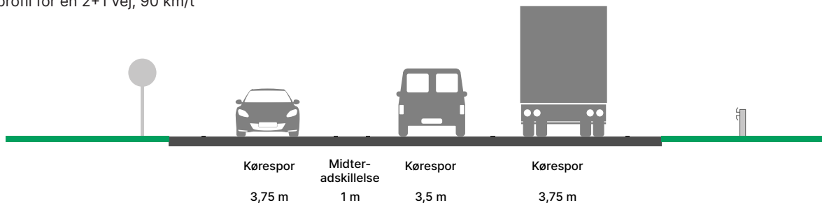
Tværsprofil for en 2+1 vej, 90 km/t
