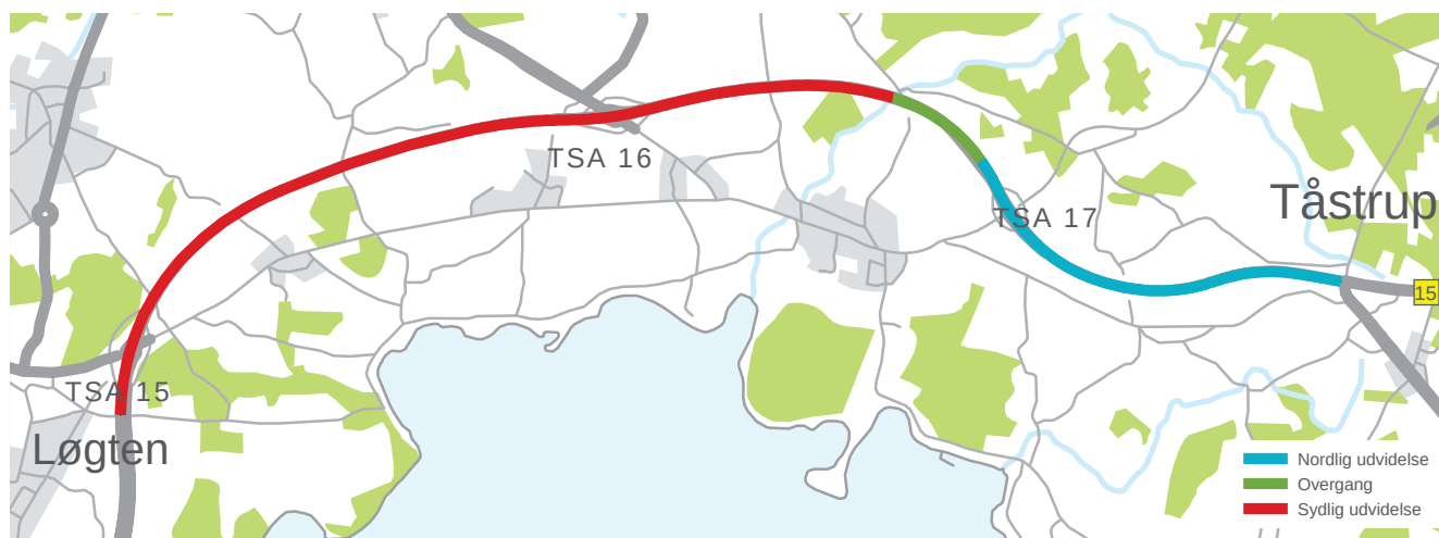
FIGUR 4.2 Forslag til asymmetrisk udbygning til motorvej
