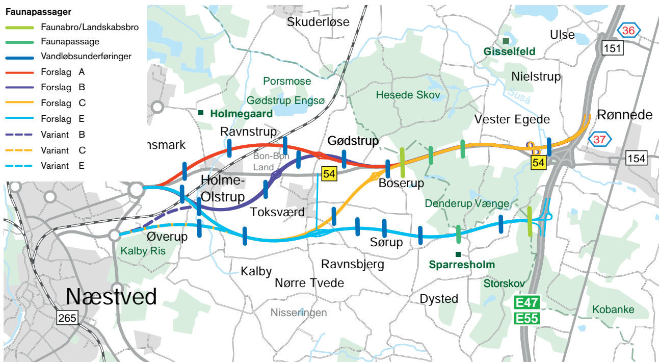
Figur 7. 18 Faunapassager og vandløbsunderføringer på forslag A, B, C og E.
