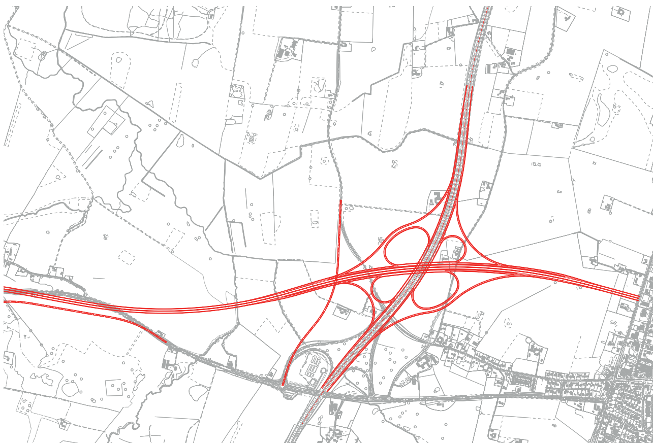
Figur 3.26 Skitse af Kløverbladsanlægget (tilvalg) ved Sydmotorvejen.
