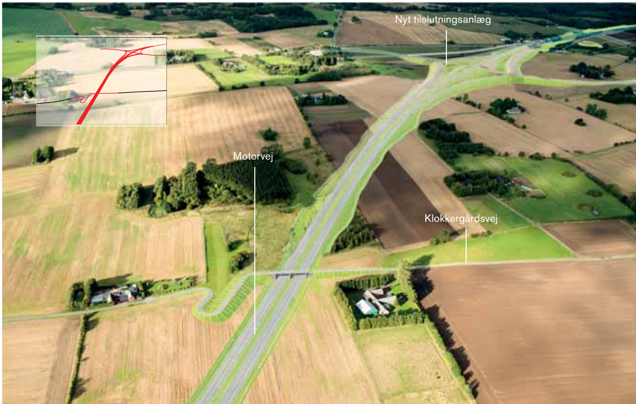
Figur 7. 11 Forslag C som forløber øst om Toksværd med tilslutningsanlægget ved Boserup og den eksisterende Rute 54.
