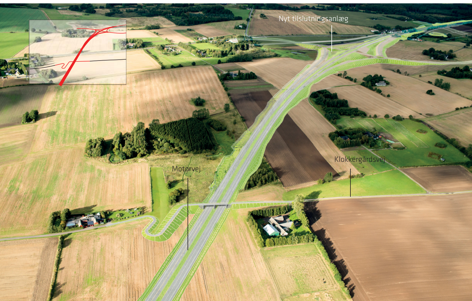
Fig. 30 - Motorvejens møde med den eksisterende Rute 54. I baggrunden ses tilslutningsanlægget. Klokkegårdsvej lukkes, og føres over motorvejen som dobbeltrettet fællessti.
