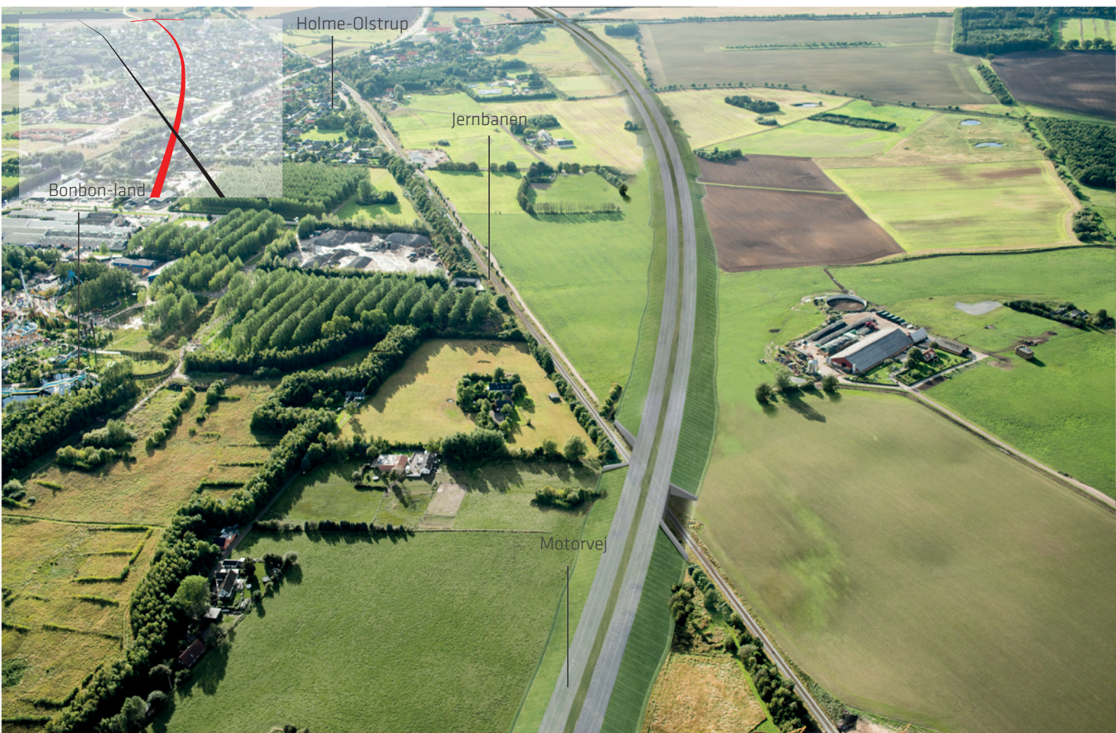
Fig. 5 - Forslag A krydser henover jernbanen. Motorvejen løber på en dæmning og er et markant element i landskabet.
