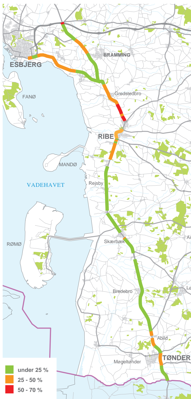
FIGUR 3.5 Belastningsgrad for eksisterende rute 11 og rute 24
