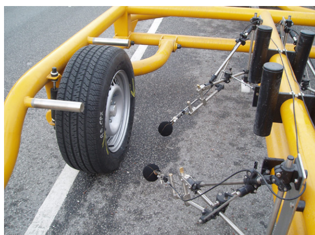
Figur 3.6: Vejdirektoratets støjtrailer deciBella. På billedet til højre ses det, at mikrofonerne sidder meget tæt på kontaktpunktet mellem måledæk og vejoverflade.
