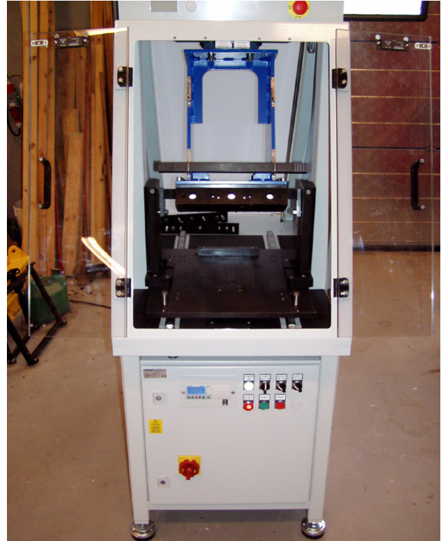
Figur 7.3: Tromleapparat til komprimering af prøvepladerne til sporkøringsapparatet.
