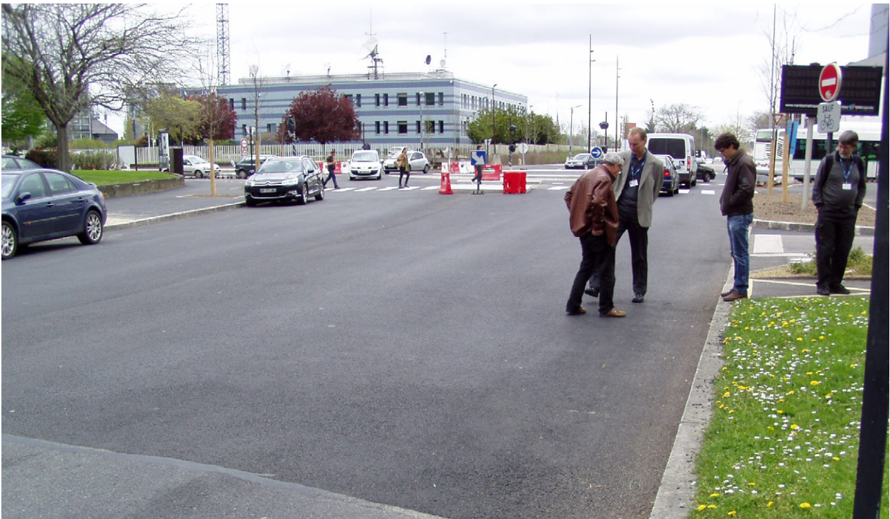
Figur 2.5: Boulevard Alexandre Millerand, Nantes. Overgang fra støjreducerende belægning (Microphone® 0/6 mm) til tæt asfaltbeton (AB 10t), som benyttes i decelerationsstykket op til og i rundkørslen.
