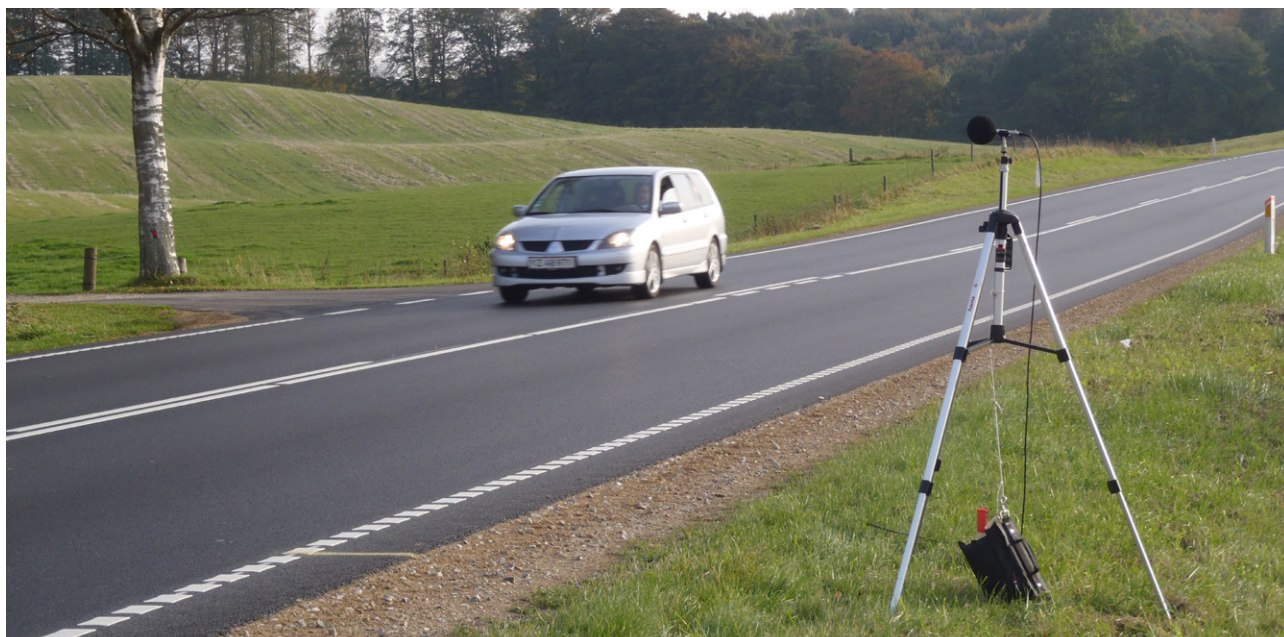
Figur 3.5: Mikrofonopstilling i vejsiden ved udførelse af SPB-støjmåling.
