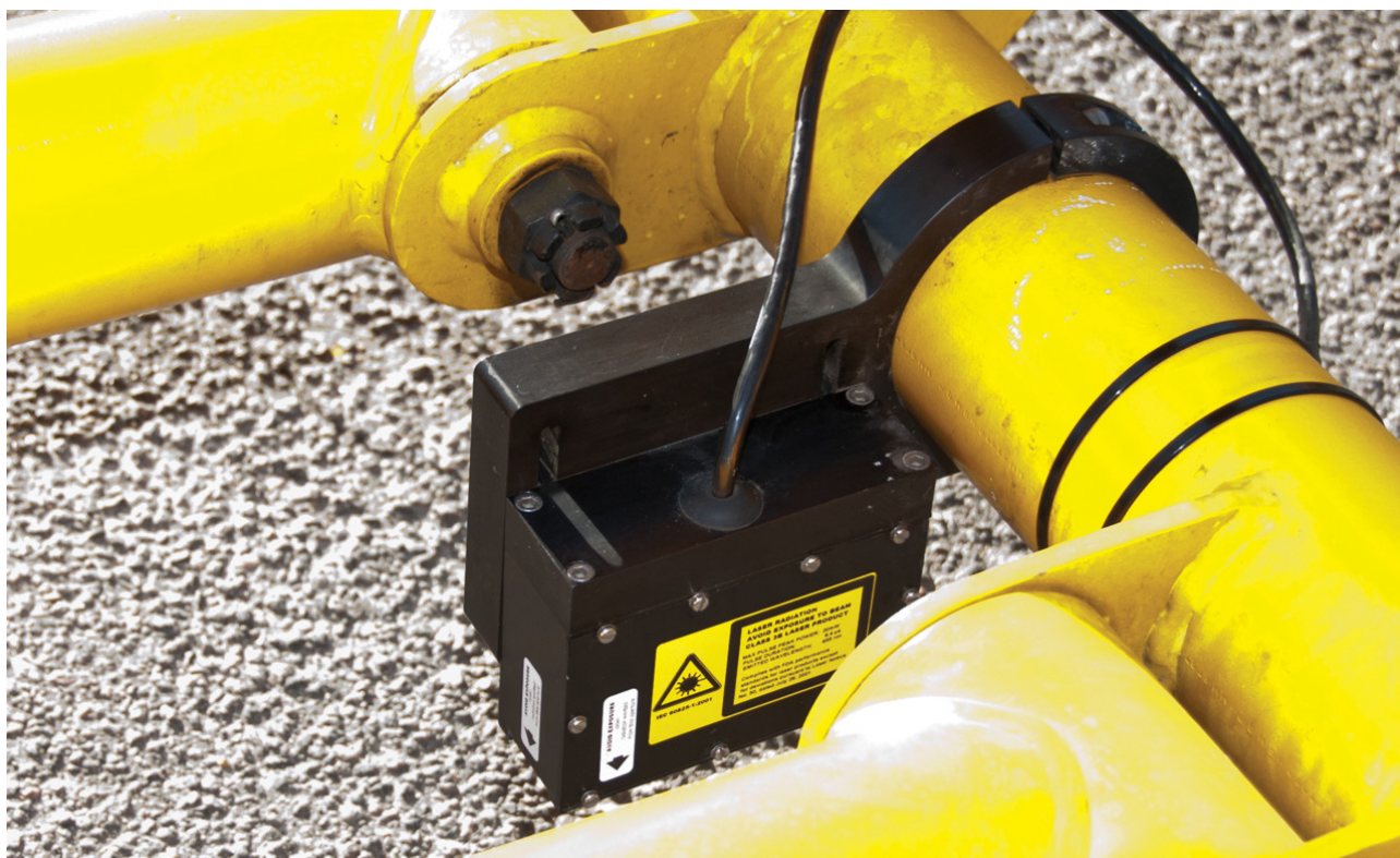
Figur 5.3: Teksturlaser monteret på Vejdirektoratets CPX-støjmåletrailer "deciBella" til måling af tekstur i hjulspor.
