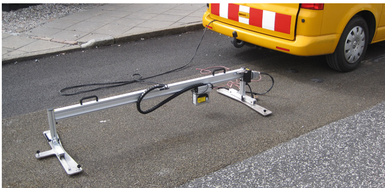
Figur 5.4: Vejdirektoratets nye laserbaserede tekstur-måleudstyr "In-situ-TEX" på forsøgsbelægning. I baggrunden ses målebilen med interfacebox og strømforsyning samt PC med måleprogrammet.
