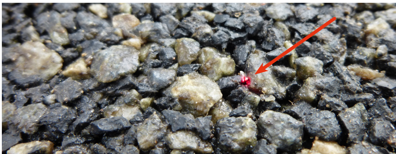
Figur 5.5: Close-up foto af en vejoverflade, hvor laserens røde laser lysplet tydeligt ses ved den røde pil.
