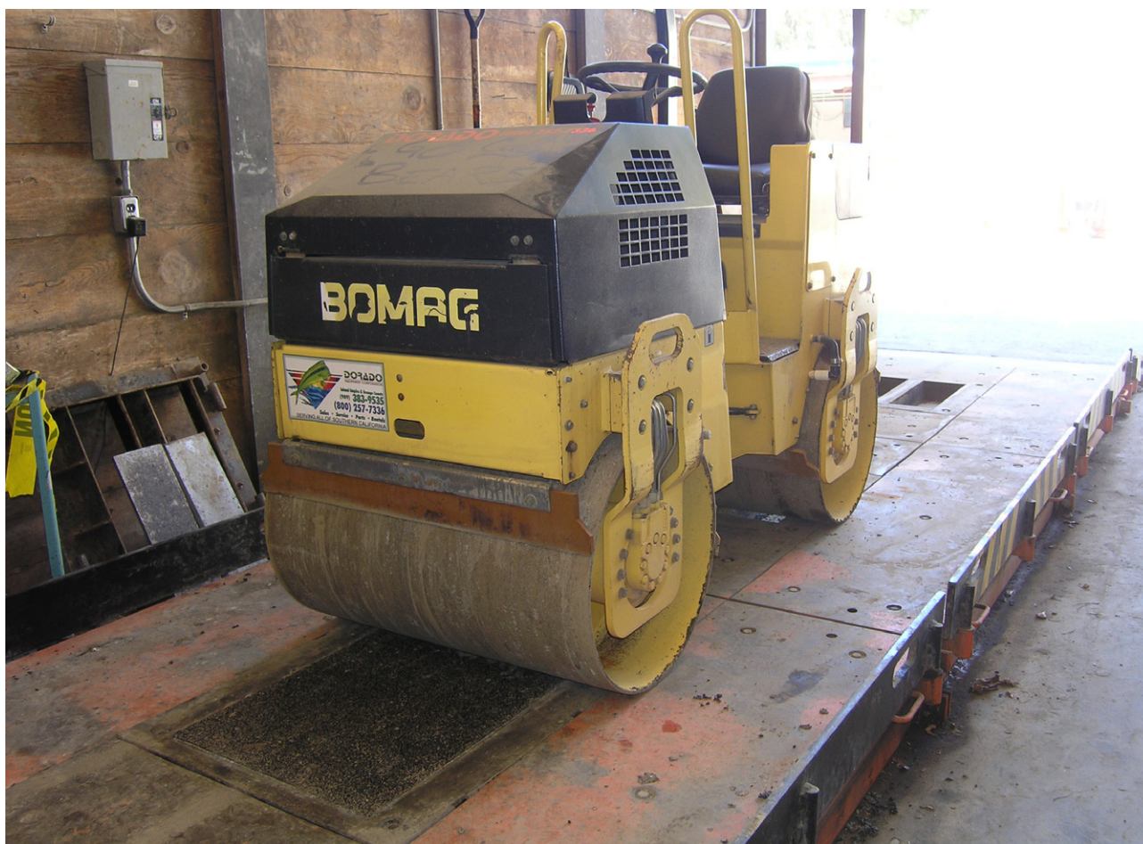
Figur 6.4: Prøveplader af støjreducerende slidlag blev komprimeret med en lille tromle.
