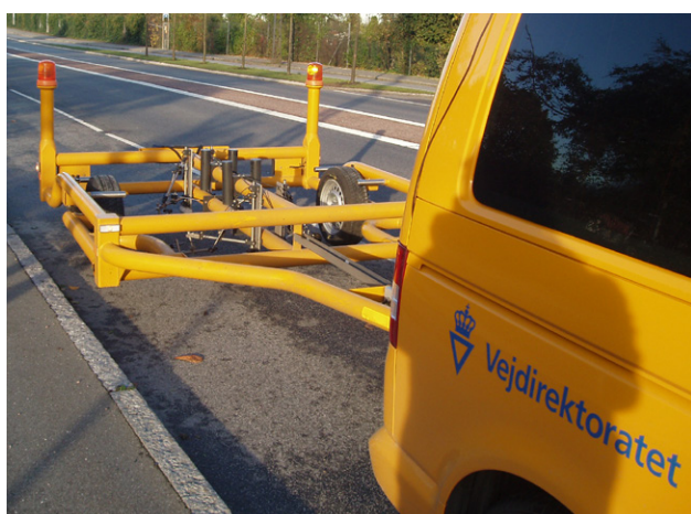
Figur 3.6: Vejdirektoratets støjtrailer deciBella. På billedet til højre ses det, at mikrofonerne sidder meget tæt på kontaktpunktet mellem måledæk og vejoverflade.
