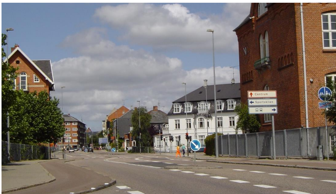
Figur 7.13 Tosidig mastepacering er nødvendigt på trafikveje med 3-4 kørespor, og det er ønskeligt, når der er stor fodgænger- og cykelfærdsel i begge vejsider.
