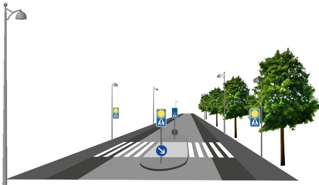
Figur 7.31 Princippet for belysning til fodgængerfelt med armaturer på korte arme. Armaturet har en speciel reflektor med stærkt asymmetrisk lysfordeling, som koncentrerer lyset på fodgængerfeltet.
