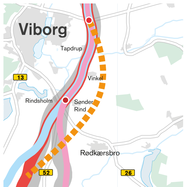
Figur 4.8 Forslag til ændring af motorvejens linjeføring øst for Viborg vist med orange. Korridorerne fra den strategiske analyse er vist med grå
